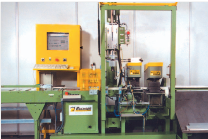
Vollautomatisches Positionieren an einer automatisierten Säge-Bohr-FräS-Stanz-Kombination mit integriertem Materialabtransport
